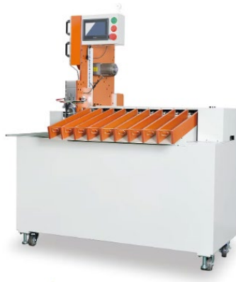
Figura 84 – Máquina de separação de células por IR e tensão
