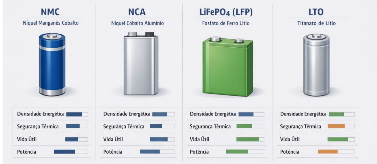
Figura 10 – Principais químicas - células de lítio: NMC, NCA, LFP e LTO.
