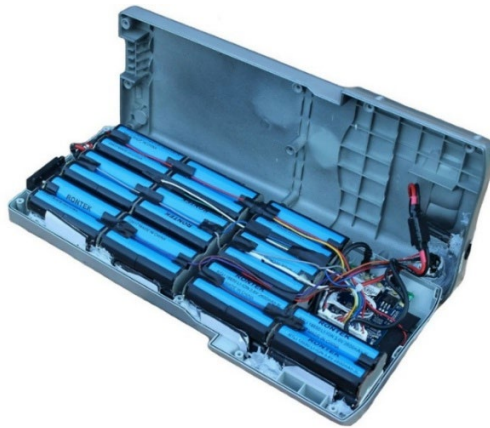
Figura 23 - Pack de baterias com 40 células de lítio-íon para e-bike
