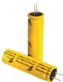
2,4V 1300mAh • Titanato de Lítio • 18x65mm • Descarga máx: 13A • Carga máx: 2,6A 035808
