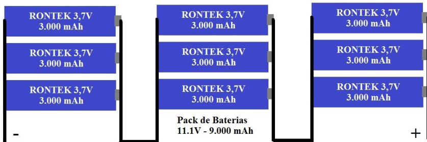
Figura 68 - Baterias ligadas em série e paralelo
